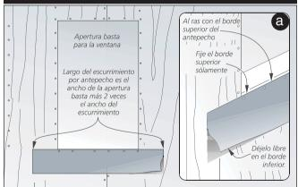
Corte el escurrimiento por antepecho (el ancho de la apertura basta más 2 veces el ancho del escurrimiento). Acople mecánicamente el escurrimiento a lo largo de la parte inferior de la apertura basta. Asegúrese de no fijar el borde inferior del escurrimiento de manera que la barrera resistente a la intemperie pueda ser deslizada abajo del escurrimiento a modo de capas solapadas (1a).
